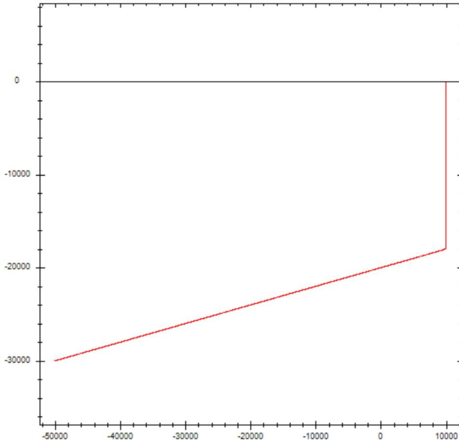
图中横坐标为 X 轴，纵坐标为 Y 轴。坐标起始点位（-50000，-30000），以 G\_PTP 运行后，X、Y 轴分别以各自的默认速度运动到目标位置（10000,0）处。
