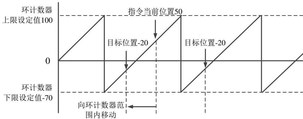
Direction（方向选择）为“无方向指定”时，可指定超出环计数器上下限设定值范围的 Position（目标位置）指定了超过环计数器上限设定值的 Position（目标位置）时，将超出设定值的移动量作为吵过后的相对量进行定位。因此，可实现环多圈定位。
