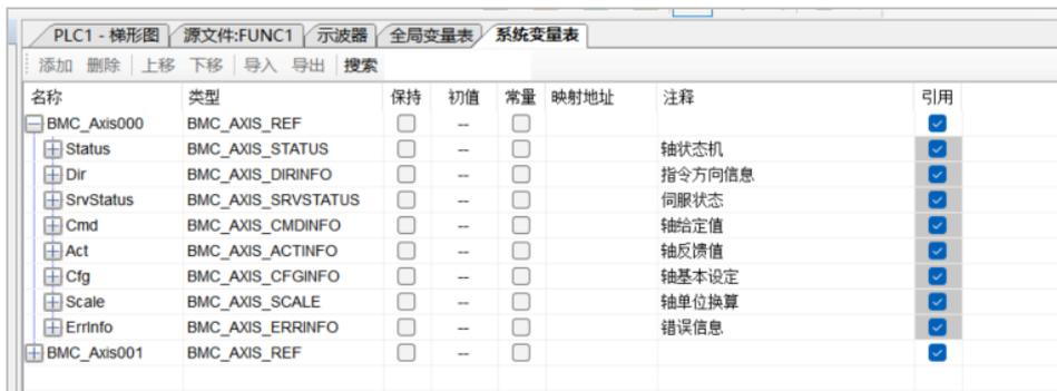
3、将轴结构体变量添加到自由监控界面可以监控轴的状态、运动方向、轴位置、轴反馈等状态参数；
