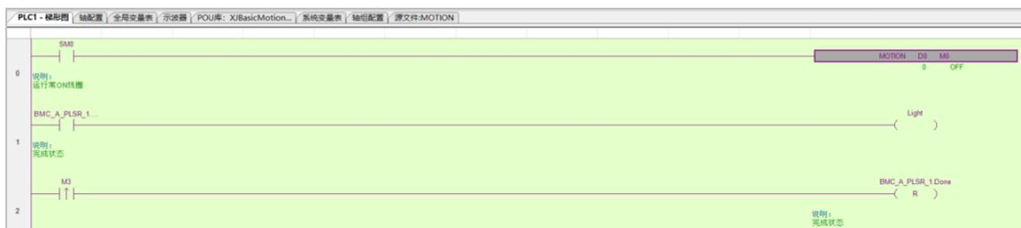
PLC 上电后，先导通 M0 线圈使能轴 0，再触发 M1 信号即可使轴 0 开始运动往返运动，往运动完成后，BMC\_A\_PLSR\_1.Done 完成信号置位，导通 Light 映射的 Y0 端子，使接 Y0 端子的小灯亮起，触发 M3 信号即可熄灭小灯。
