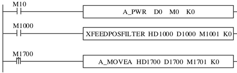
**XFEEDPOSFILTER指令参数配置**
