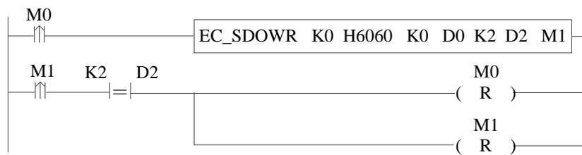
操作数 S6（M1）置起后，检查 S5（D2）状态，根据状态码，如指令处理成功，则可对读取寄存器进行赋值等操作。由于完成标志 M1 不会主动复位，需手动复位，因此 RST M1。
