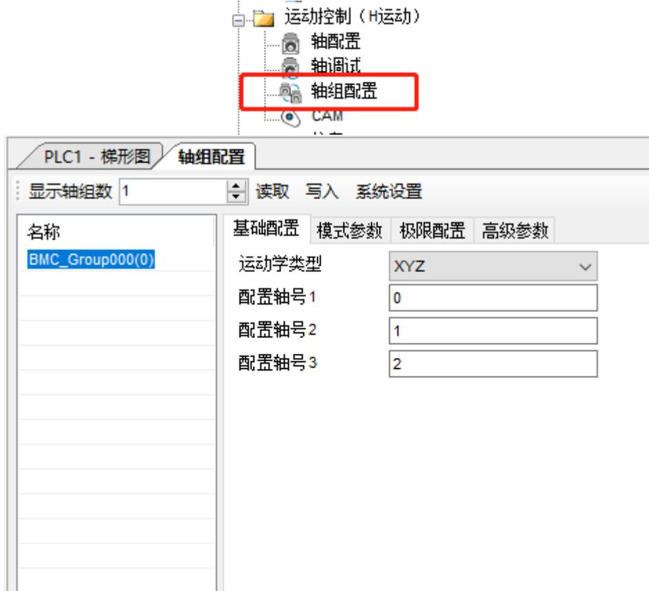
(目前运动学类型仅支持 XYZ，如需要 XY 类型可将 Z 轴对应单轴的轴类型 SFD8000+300\*N 修改为虚轴)
