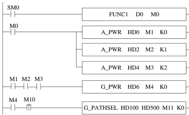
其中，FUNC1 功能块的作用是给 G\_PATHSEL 指令赋值，当 M0 开启轴组组成轴使能，三个轴使能都开启成功后（M1、M2、M3 为 ON），开启轴组使能。轴组使能开启成功后（M4 为 ON），M10 由 OFF → ON 即可触发 G\_PATHSEL 指令，指令可以单次加载所有点也可以分多次加载一定数量的点，但至少要有有一个终止行，才可以执行 G\_PATHMOV 指令。
