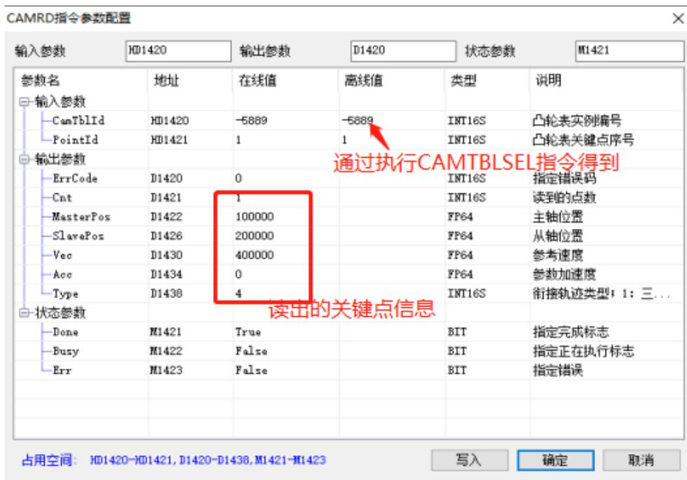
其中凸轮表实例编号是通过 CAMTBLSEL 指令得到的，关键点序号应从 0 开始，0 表示凸轮表的第一个点 (0,0)。
