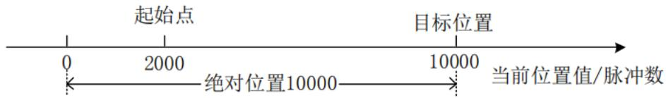
指令中的目标位置即为零点目标点之间的绝对位置，所以移动到 10000 个脉冲的位置需要设目标位置 10000，同理，移动到 20000 个脉冲的位置需要设目标位置 20000。
