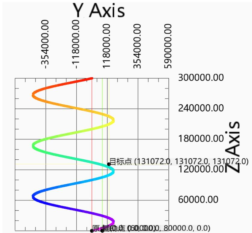
动作分解：XOY 平面两轴做平面圆动作，圆轨迹由所选平面上起点，辅助点和目标标点坐标决定，圆运动重复圈数 3 次；Z 轴匀速直线运动，运动距离为圈数×螺距；三轴同时启停，三轴线速度分解为 XOY 平面线速度和 Z 轴直线速度。
