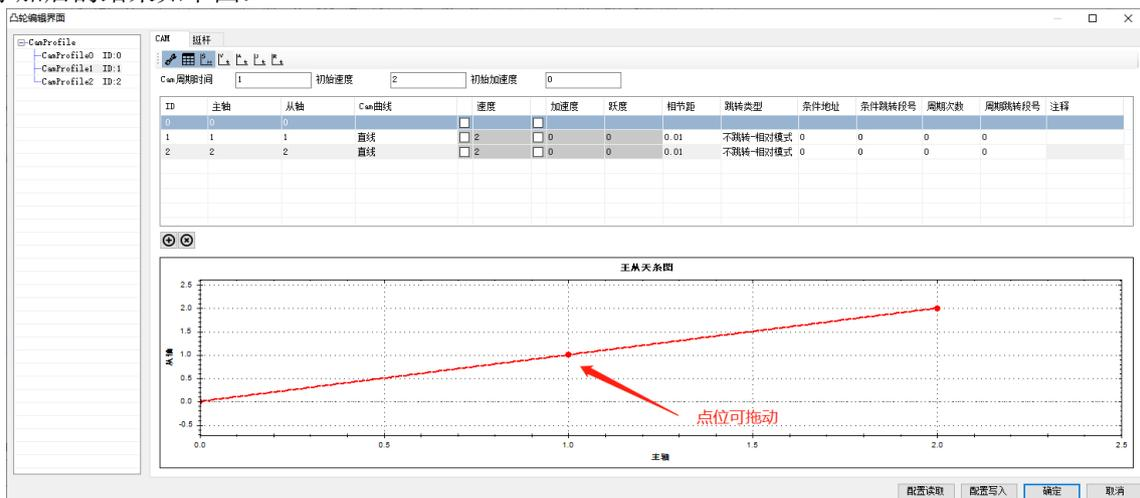
**【主轴】**：主轴的点位，双击可手动更改，后面的点位必须大于前面的点位，主轴的点数不能超过 65535，
