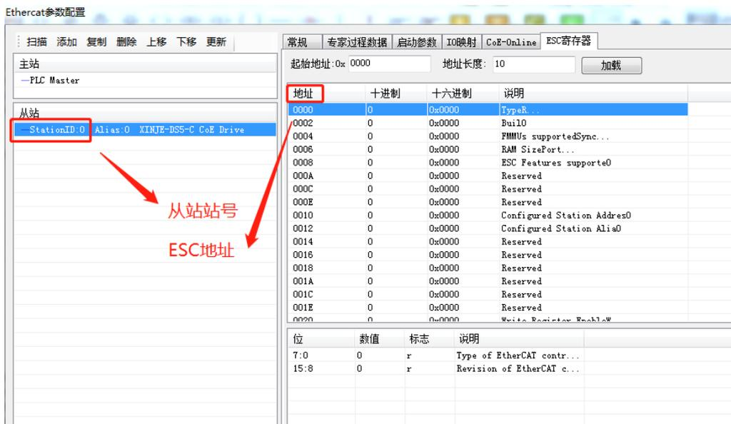
图示为 ESC 参数界面，如需要对 StationID 为 0 的从站当前 ESC 地址 H100 进行写值，以下图为例：
