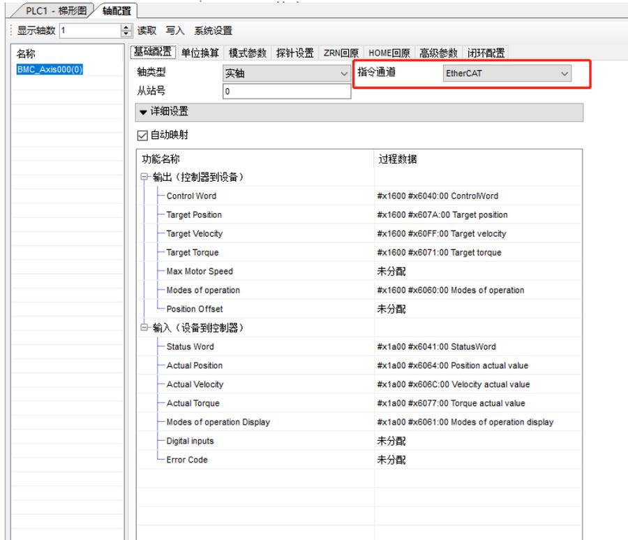
⑧ 确认参数后，通过 A\_PWR 指令给指定轴使能，使能成功后通过对应的单轴指令（此处以 A\_MOVER
