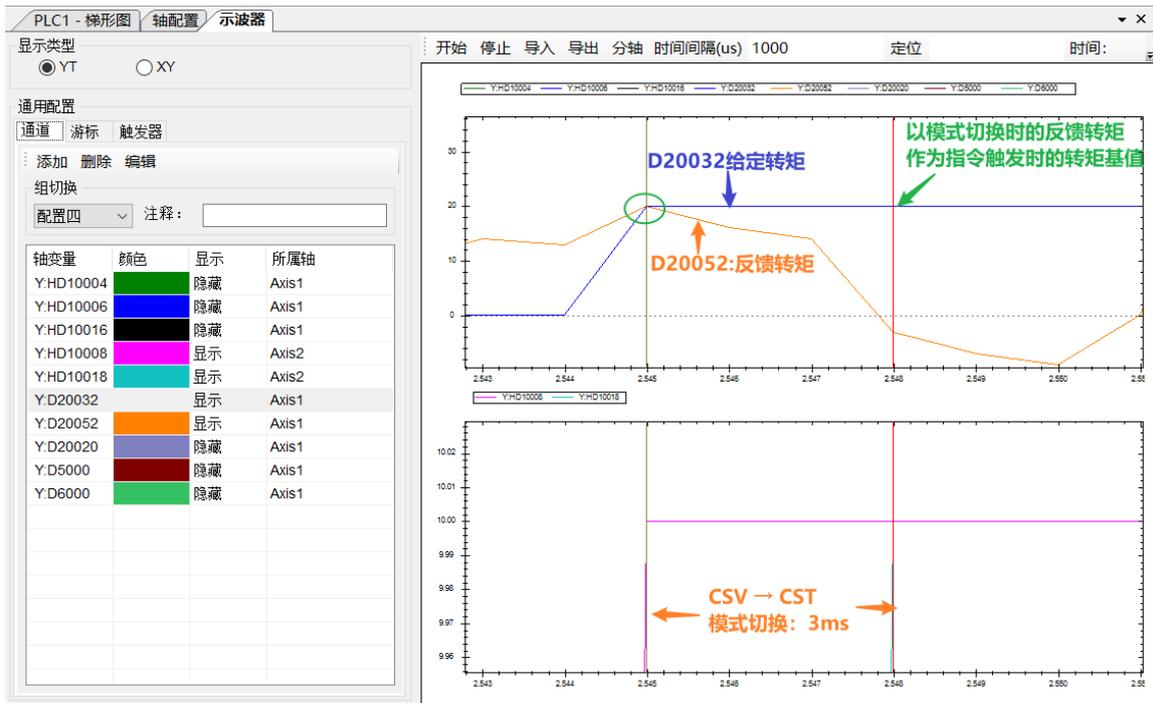
触发指令时未发生模式切换时，转矩基值为触发指令时刻反馈转矩值（如下图：A\_TORQUECTRL 打断 A\_CYCTRQ）
