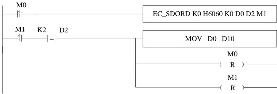
操作数 S5 (M1) 置起后，检查 S4 (D2) 状态，根据状态码，如指令处理成功，则可对读取寄存器进行赋值等操作。由于完成标志 M1 不会主动复位，需手动复位，因此 RST M1。
