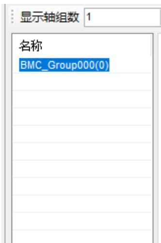
显示轴数的设置决定了配置栏的轴组个数，与实际配置的轴组数无关，仅供显示作用，实际配置的轴组个数通过 SFD820 修改。选择对应轴组号即可对轴组相关参数进行配置。
