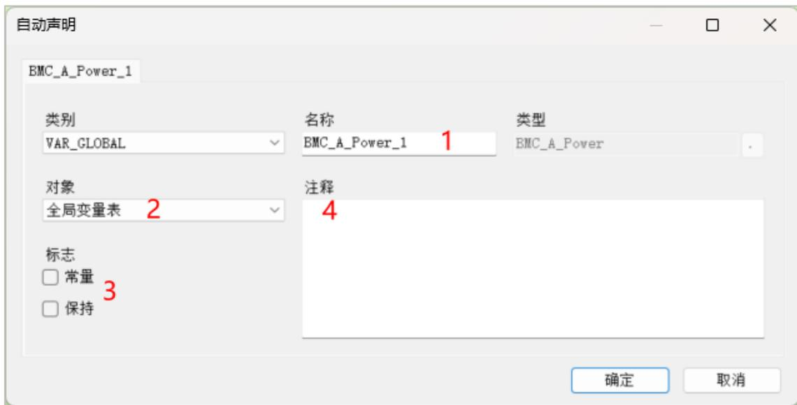
3、第 2 步的自动声明点击确定后，可在全局变量表中查看已声明的变量；
