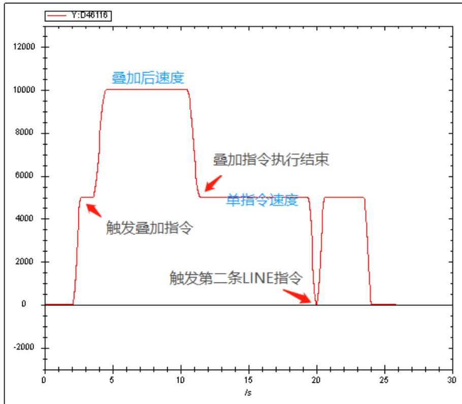
由速度曲线图可以看出，当执行叠加指令时，速度会在原速度的基础上进行叠加，在叠加指令执行结束后会见到之前的速度继续执行，直到指令执行结束速度减至 0。
