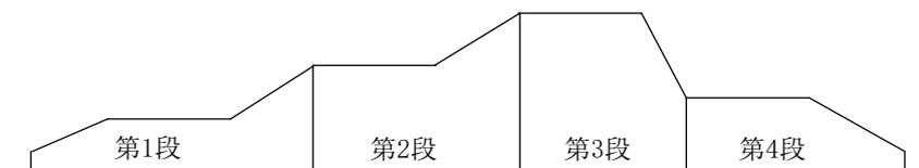
发送本段个数脉冲完成时, 已切换到后续段速度, 在此处分段除第一段脉冲外, 每个脉冲段都是由平稳部分、上升或下降部分构成。
