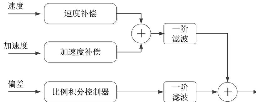
具体算法为： $60B0 = (\text{误差值} \times \text{比例系数 (ScaleCoe)} + \text{积分器数值} \times \text{积分系数 (IntegralCoe)} + \text{速度} \times \text{速度前馈系数 (VelFFCoe)} + \text{加速度} \times \text{加速度前馈系数 (AccFFCoe)}) \times \text{每圈移动换算量}$ 。
