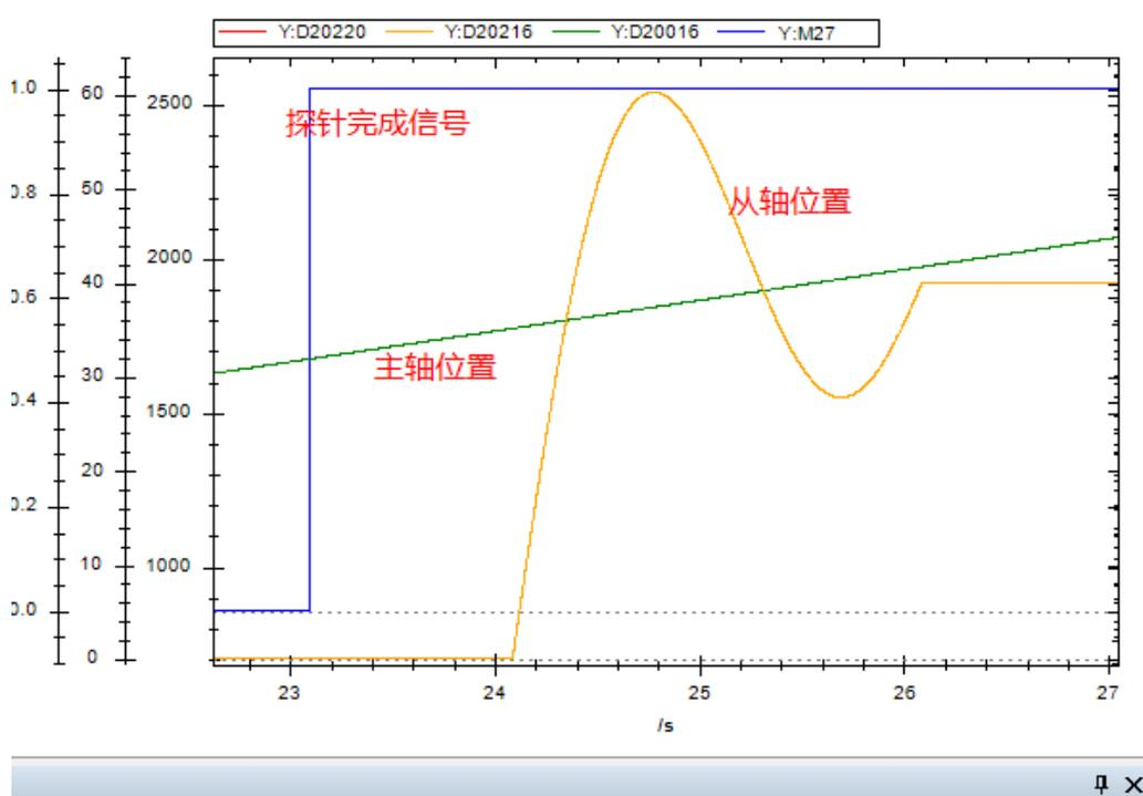
由上图可以明显看到在探针完成后到从轴开始凸轮运动，中间有着非常明显的滞后，通过游标获取这段时间的差值，可以发现这段时间内，主轴刚好运动了指令中设置的 100 的距离。
