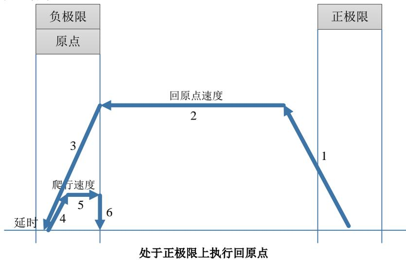
◆ 原点信号为正限位信号的情况（将原点端子和正极限配置为同一端子，会将正极限当做原点）
