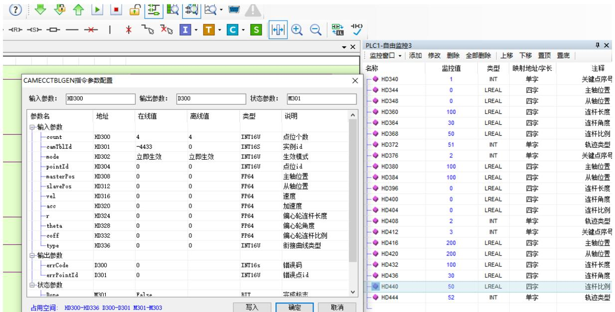
说明：首先通过 A\_PWR 指令开启主从轴使能，然后执行 CAMTBLSEL 指令加载凸轮表实例，之后执行 CAMECCTBLSEL 生成偏心轮凸轮表，然后执行 CAMIN 启动凸轮，然后执行 A\_VELMOVE 运动主轴（主轴速度设置为 100），最后执行 CAMECCCALC 计算偏心轮点位信息与读出的凸轮表点位进行对比。执行凸轮，凸轮轨迹如下图所示：
