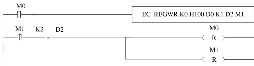
操作数 S5（M1）置起后，检查 S4（D2）状态，根据状态码，如指令处理成功，则可对读取寄存器进行赋值等操作。由于完成标志 M1 不会主动复位，需手动复位，因此 RST M1。
