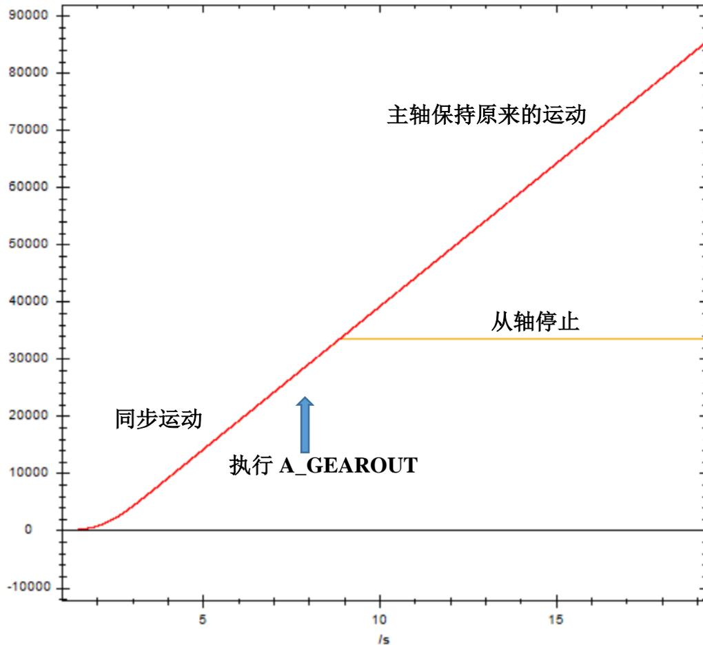
其中红色为主轴位置曲线，黄色为从轴位置曲线，执行 A\_GEAROUT 后，主轴保持原来的运动，从轴以 A\_GEARIN 指令和 A\_GEAROUT 指令中较大的减速度停止。
