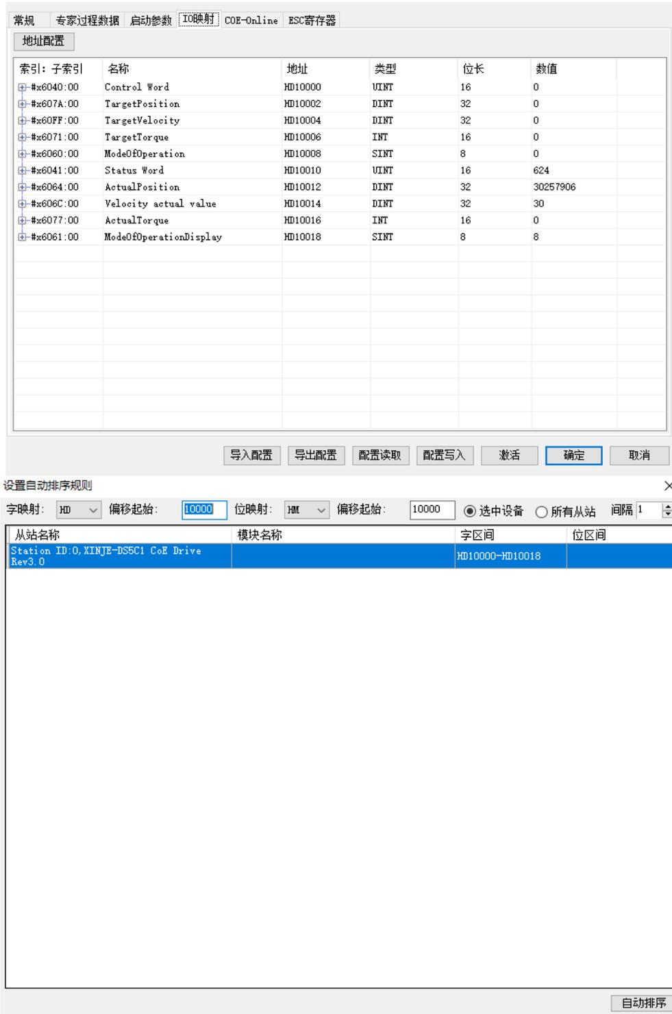
点击地址配置，可以设置自动排序规则，会将分配的 RxPDO、TxPDO 映射到【偏移起始】开始的寄存器中，寄存器类型可选 HD、D，修改【偏移起始】地址，点击自动排序，会按照参数顺序自动排列地址，如果有地址与其他站重复会报错并自动排到不重复的地址。
