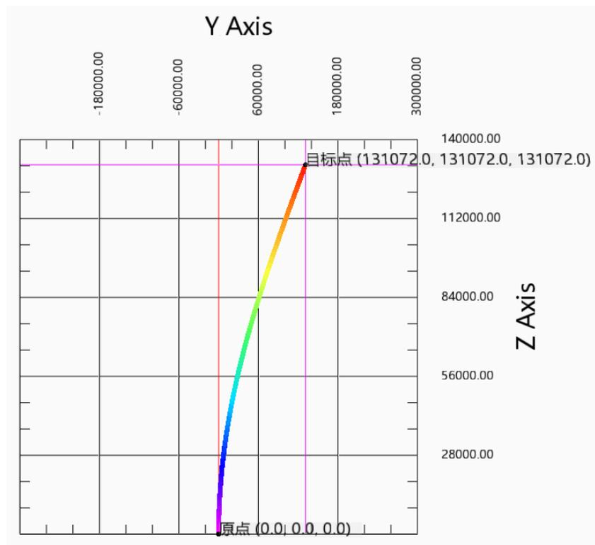
动作分解：XOY 平面两轴做平面圆弧动作，圆弧轨迹由所选平面上起点，半径，目标点坐标，旋转方向（Z 轴正负）和圆弧类型；Z 轴匀速直线运动，运动距离为 Z 轴起点与目标点的差值；三轴同时启停，三轴线速度分解为 XOY 平面线速度和 Z 轴直线速度。
