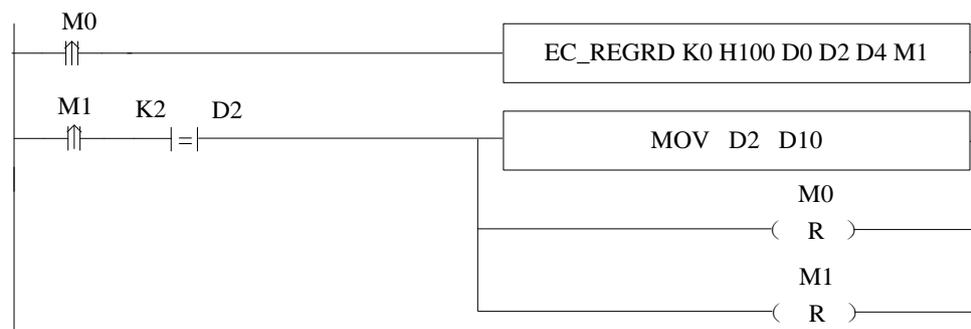
操作数 S5（M1）置起后，检查 S4（D2）状态，根据状态码，如指令处理成功，则可对读取寄存器进行赋值等操作。由于完成标志 M1 不会主动复位，需手动复位，因此 RST M1。
