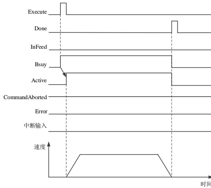
ErrorDetect (错误检测选择): 有异常检测模式, 运动结束且无中断输入时, 指令 Error 置位。
