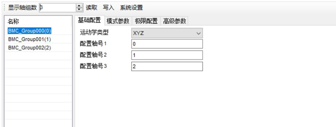
轴组 0 的组成轴通过 SFD48001、SFD48002、SFD48003 设置，需要轴组的所有组成轴开启使能后才能开启轴组使能。轴组使能开启后，对应的轴组状态机 D46000+300\*N 变为 1，表示轴组使能中。轴组组成轴的单轴状态机 D20000+200\*N 变为 8，表示该轴处于轴组中。单轴相关寄存器详见 5-1-3，轴组相关寄存器详见 5-2-3。
