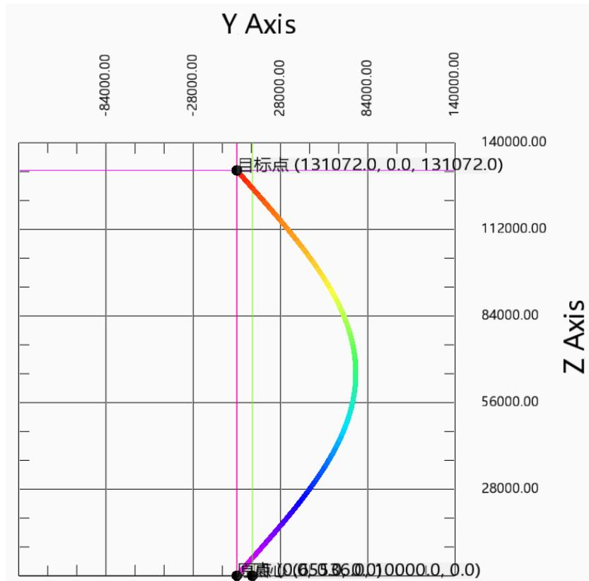
动作分解：XOY 平面两轴做平面圆弧动作，圆弧轨迹由所选平面上起点，圆心，目标标点坐标和路径选择决定；Z 轴匀速直线运动，运动距离为 Z 轴起点与目标点的差值；三轴同时启停，三轴线速度分解为 XOY 平面线速度和 Z 轴直线速度。
