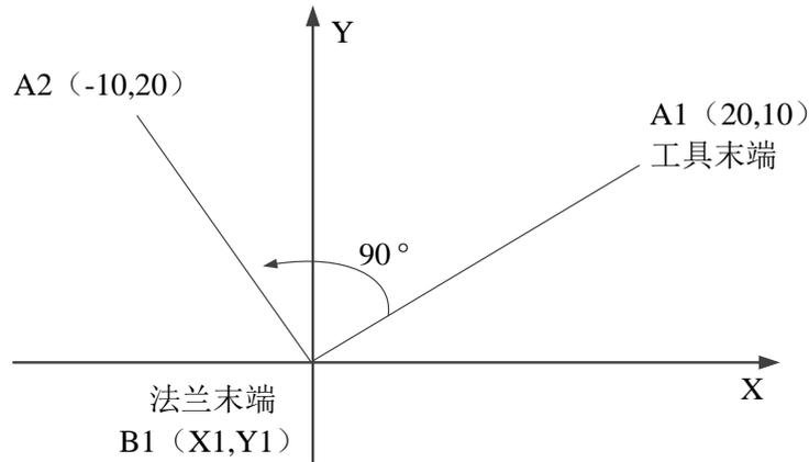
由图可以看出，工具末端在 XOY 平面旋转了 90° 后，其坐标值为 (-10,20,0,90)，与指令中目标位置不一致，此时就需要法兰末端对工具末端进行补偿： $X_B = X_{A2} + X_1$ ， $Y_B = Y_{A2} + Y_1$ ，最后通过计算可以得出  $X_1 = 30$ ， $Y_1 = -10$ ，即旋转 90° 后法兰末端的 x 与 y 的值。此时法兰末端的坐标值。
