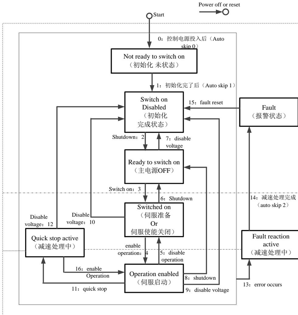
迁移到Operation enabled (伺服使能开启)后，请提升到100ms以上时间，输入动作指令。
