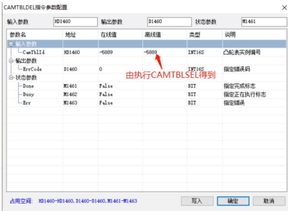
凸轮表实例编号是由 CANTBLSEL 指令生成,指令执行后会将该实例卸载。若实例编号已经被 CAMIN 指令启动,则需要先执行 CAMOUT 指令进行凸轮关系解除,再执行卸载指令。
