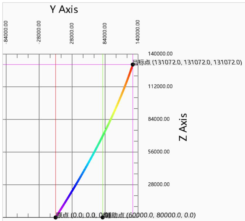
动作分解：XOY 平面两轴做平面圆弧动作，圆弧轨迹由所选平面上起点，辅助点和目标点坐标决定；Z 轴匀速直线运动，运动距离为 Z 轴起点与目标点的差值；三轴同时启停，三轴线速度分解为 XOY 平面线速度和 Z 轴直线速度。
