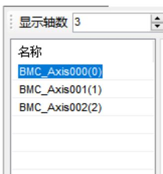
显示轴数的设置决定了配置栏的轴个数，与实际连接的轴数无关，仅供显示作用。选择对应轴号即可对轴相关参数进行配置。
