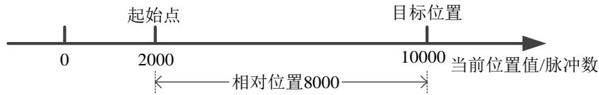
当前位置 2000，在相对位置模式下运行到 10000 个脉冲位置需要发送 8000 个脉冲，同理继续移动到 20000 个脉冲位置需要再发送 10000 个脉冲。
