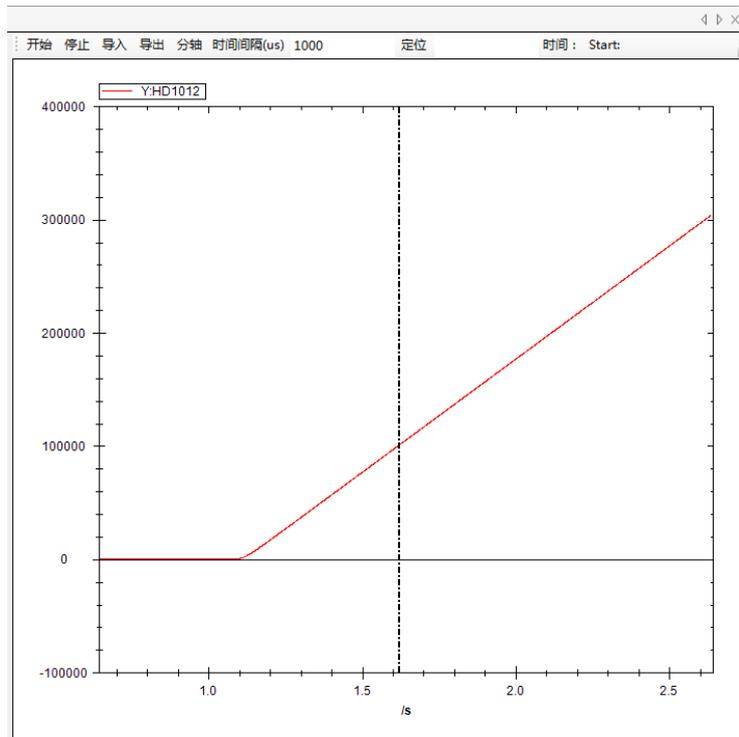
图中的虚线为触发器触发位置，当触发器触发后，触发位置占当前波形图的 4/8，示波器会停止（即虚线位置占当前波形图的一半），可以看到触发器的状态都变成了红色，表示都已被触发，触发条件选择 AND 表示两个触发器都被触发才会停止，所以触发的位置寄存器的值为 100000（如果触发条件选择 OR，其中任何一个触发器被触发都会停止，如果两个触发器触发条件一个选择 AND 一个选择 OR，则以触发条件为 OR 来判断）。
