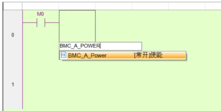
2、声明 POU 定义实例化 POU 块，使能指令 BMC\_A\_POWER 输入后，会出现自动声明；在该界面可以自定义 POU 的名称 1、确定 POU 块的定义所在变量表 2、勾选标志 3、对本 POU 块的做注释 4，后续程序调用直接输入自定义的名称即可；
