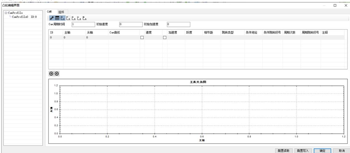
可创建多个凸轮表，凸轮表之间以 CAMID 区分，CAMID 可手动修改：
