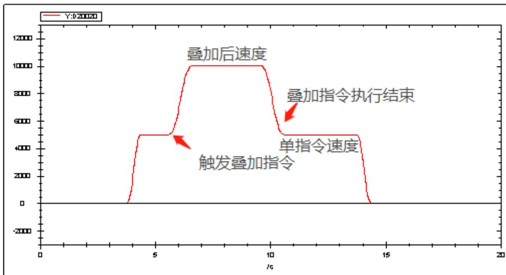
说明：在轴运动过程中触发叠加指令，两条指令会一起执行，速度会进行叠加，当叠加指令执行完需要叠加的距离后，速度会减至之前运动指令设定的速度，继续执行运动指令。
