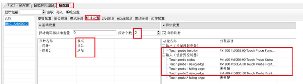
根据 PDO 分配在对应的索引中添加 PDO 参数。如上图，60B8h 为 RxPDO 在 #x1600 中添加，60B9h、60BAh、60BCh 为 TxPDO 在 #x1a00 中添加。（本例采用的是探针信号的上升沿，若采集下降沿，则在 #x1a00 中添加 60B9h、60BBh、60BDh）
