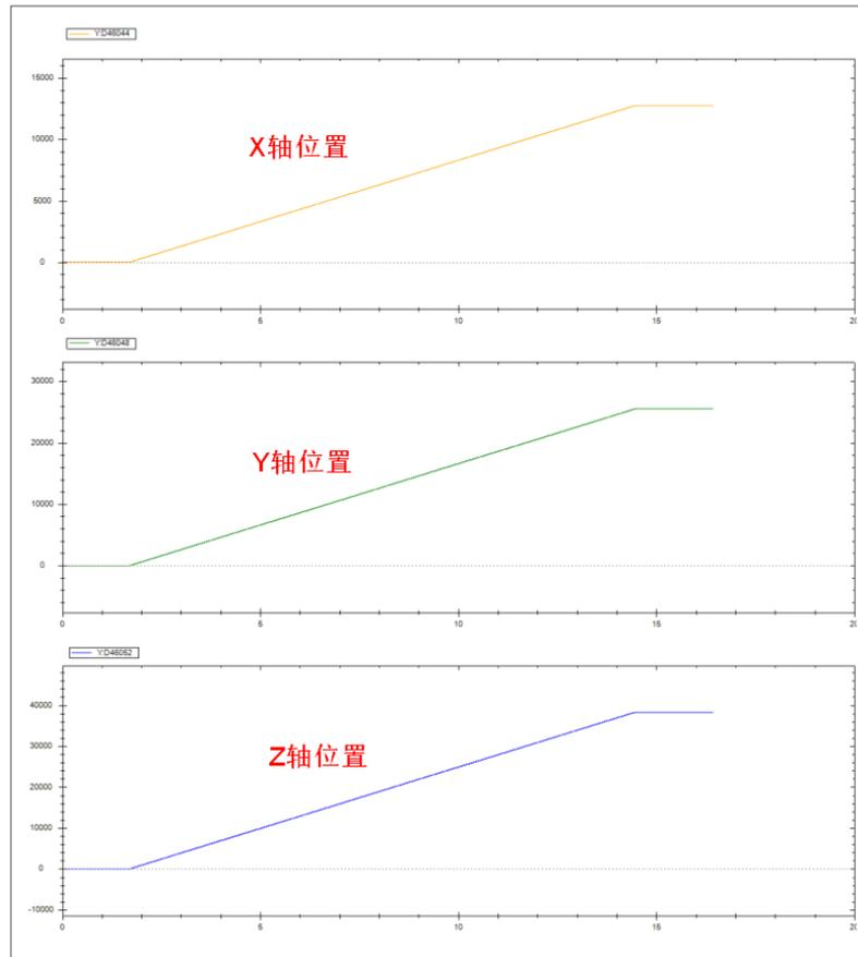
说明：通过 A\_PWR 开启三轴使能，确认使能成功后，通过 G\_PWR 开启轴组使能轴组使能成功后。置位 SM1995 开启 I9900 中断，将 M20 由 OFF→ON，指令执行成功后，M21 由 OFF→ON 每个总线周期 X 轴增加 1、Y 轴增加 2、Z 轴增加 3，轴组各轴位置按照指令中的位置实时运动。（若出现前后两个周期位置偏差过大，会造成轴位置阶跃或者伺服报警，请注意位置规划避免出现该情况。）
