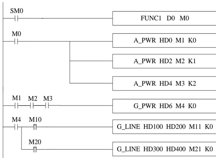
其中, FUNC1 功能块用作给 G\_LINE 指令赋值, M0 开启各轴的使能, 当三个轴使能都打开时 (标志位 M1、M2、M3 为 ON), 开启轴组使能。在轴组使能开启后 (标志位 M4 为 ON), 当 M10 置 ON 时执行第一条 G\_LINE 指令, 当 M20 置 ON 时执行第二条 G\_LINE 指令。
