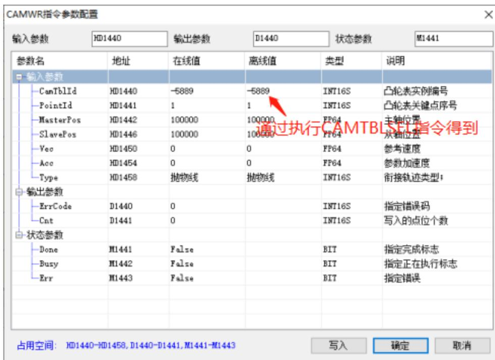
其中，凸轮表实例编号通过 CAMTBLSEL 得到，关键点序号应从 1，即第二个关键点开始（第一个关键点 (0,0) 不允许修改）。
