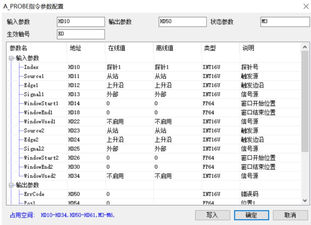
说明：探针触发源选择从站时，需要专家过程数据配置探针功能相关参数 60B8h、60B9h、60BAh、60BCh，并在轴配置-探针配置界面配置选择探针模式为从站，勾选自动映射成功分配地址后，触发 A\_PROBE 指令即可开启探针，探针信号端子由从站设置，以 DS5C 为例，P5-62 和 P5-63 用于探针功能的端子分配，P5-62 默认值为 5，即探针 1 端子为 P-，P5-63 默认值为 6，即探针 2 端子为 D-，探针 1 只能分配到 P-，探针 2 只能分配到 D-。探针开启时，每当探针端子的电平信号发生跳变，探针就会被触发，此时会将当前位置值存入探针锁存位置（指令中 S1+4、S1+8 指定的寄存器地址）。
