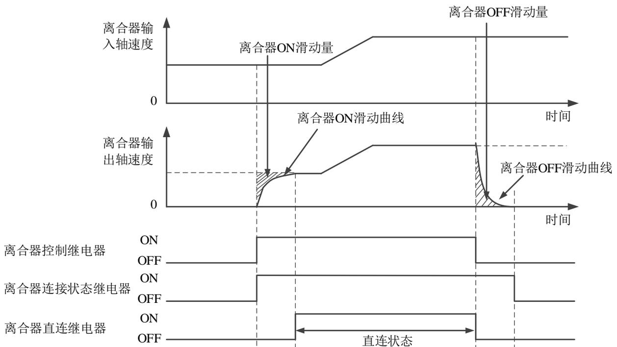
离合器 ON 时，输入轴经过指定的滑动量，输出轴达到同步状态。
