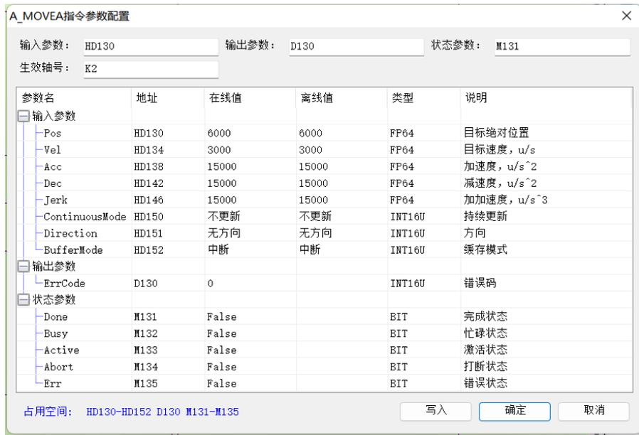
说明: 首先通过 A\_PWR 指令打开使能, 当 M10 由 OFF→ON, 开启多轴合成指令, 然后 M100 由 OFF→ON 主轴 1 以设定好的参数运行, M130 由 OFF→ON 主轴 2 以设定好的参数运行, 到达目标位置后指令的状态参数 M3 由 OFF→ON。
