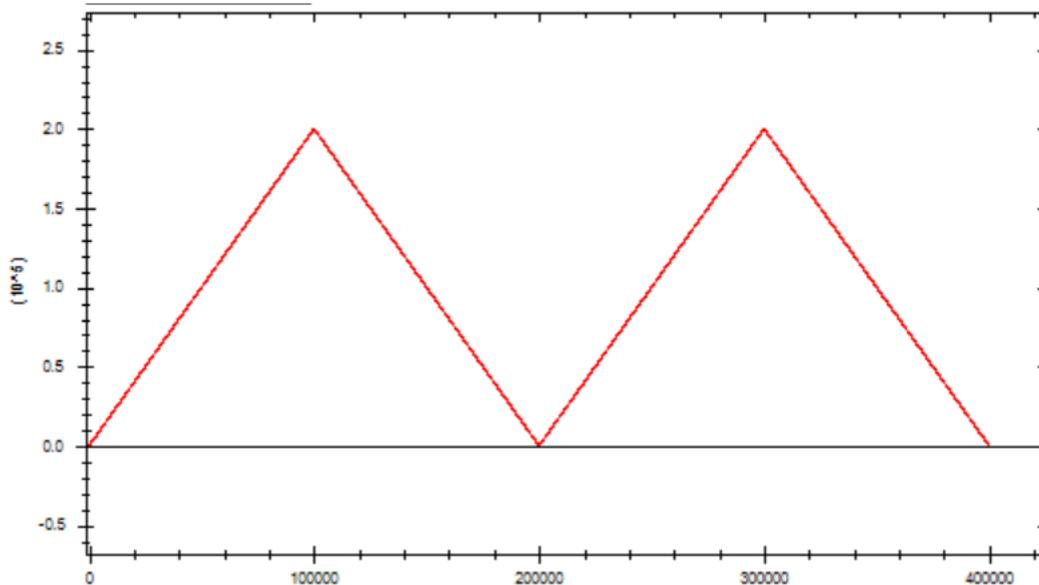
图中 X 轴为主轴位置，Y 轴为从轴位置，当主轴位置由 0 到 200000 时，从轴根据凸轮表点位做相应的运动，当主轴位置由 200000 到 400000 时，从轴做新一循环的凸轮运动。
