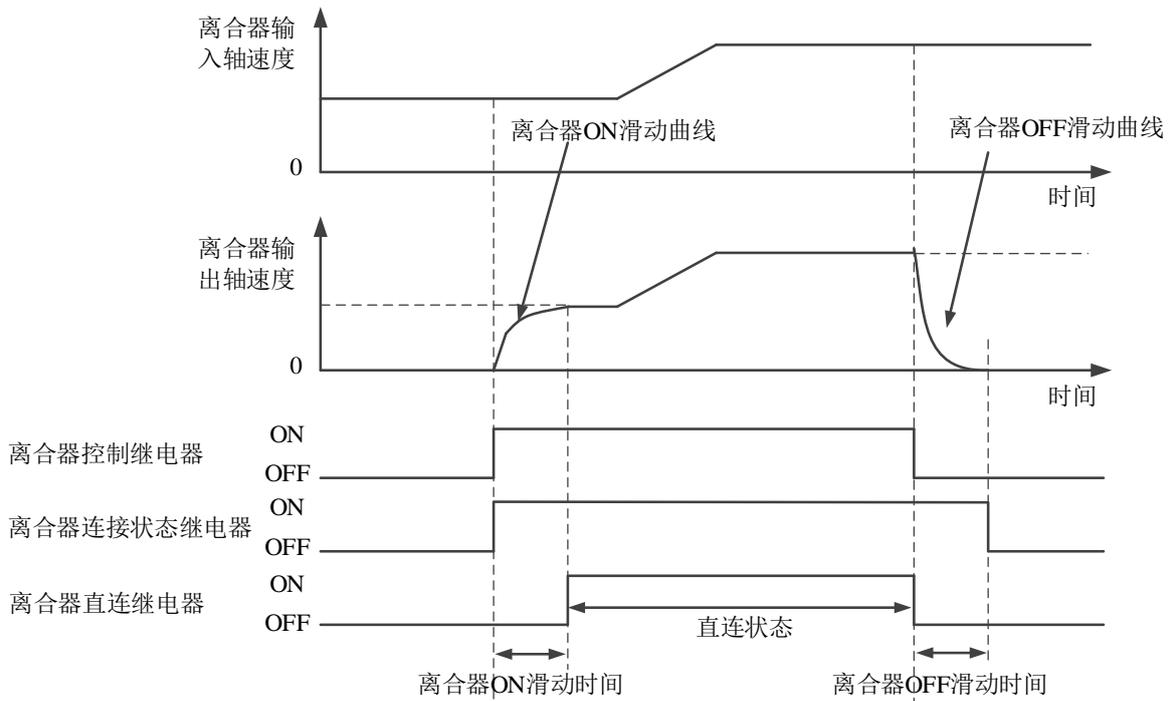
当离合器 ON 设置滑动方式为时间时，经过设置的滑动时间，输出轴达到同步状态。
