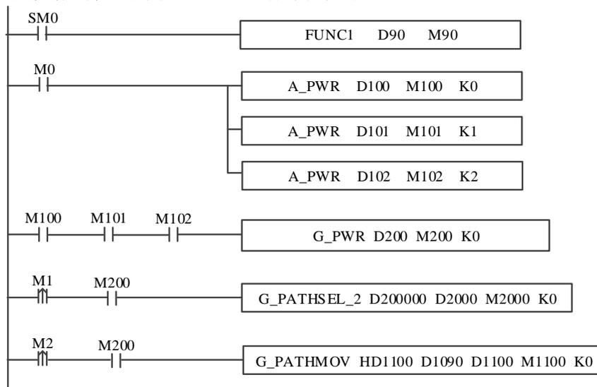
其中，FUNC1 功能块的作用是给 G\_PATHSEL 指令赋值，当 M0 开启轴组组成轴使能，三个轴使能都开启成功后（M100、M101、M102 为 ON），开启轴组使能。轴组使能开启成功后（M200 为 ON），M1 由 OFF→ON 即可触发 G\_PATHSEL 指令，M2 由 OFF→ON 即可触发 G\_PATHMOV 指令。
