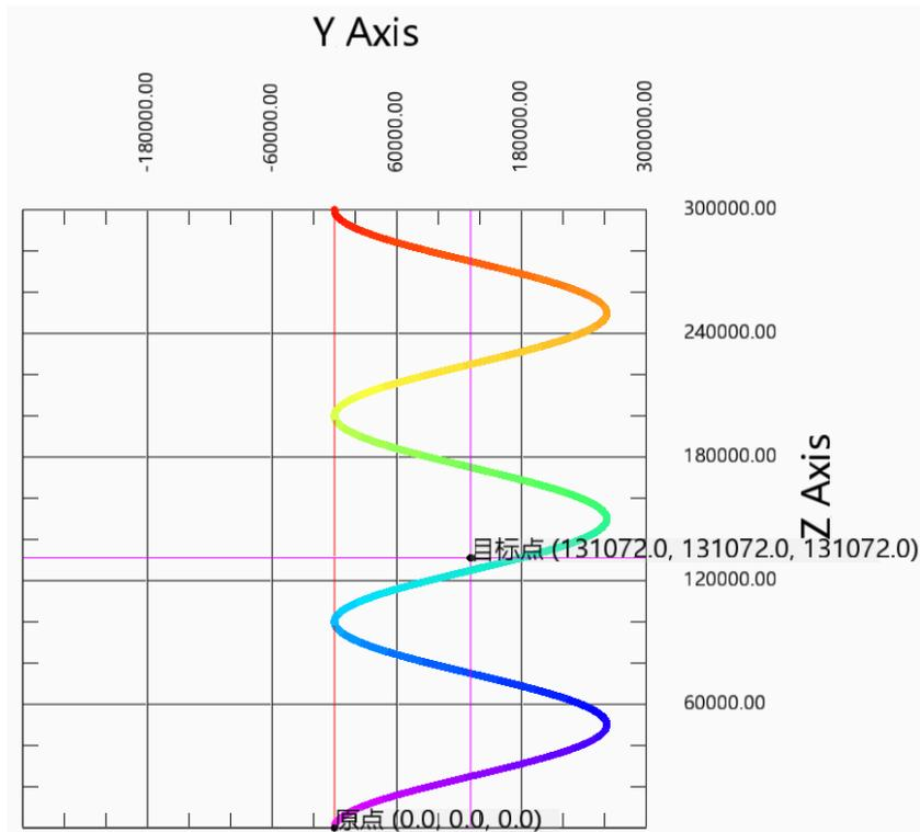
动作分解：XOY 平面两轴做平面圆动作，圆轨迹由所选平面上起点，半径，目标标点坐标，旋转方向（Z 轴正负）和圆弧类型，圆运动重复圈数 3 次；Z 轴匀速直线运动，运动距离为圈数×螺距；三轴同时启停，三轴线速度分解为 XOY 平面线速度和 Z 轴直线速度。
