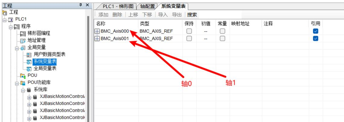
2、使用轴结构体变量需要勾选系统变量表中的“引用”；没有勾选“引用”，此变量不生效；
