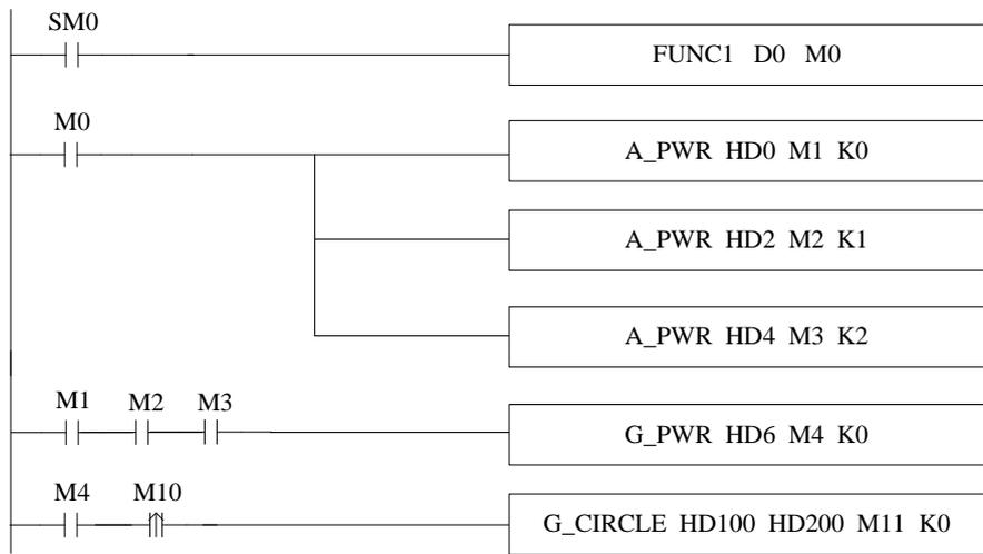
其中，FUNC1 功能块用作给 G\_CIRCLE 指令赋值，M0 开启各轴的使能，当三个轴使能都打开时（标志位 M1、M2、M3 为 ON），开启轴组使能。在轴组使能开启后（标志位 M4 为 ON），当 M10 置 ON 时执行设置好的 G\_CIRCLE 指令。
