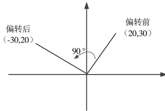
由图可知，工具值在经过 90° 的偏转后得到后的工具值为 (-30,20)，再经过工具指令后，各轴的位置如下图所示：
