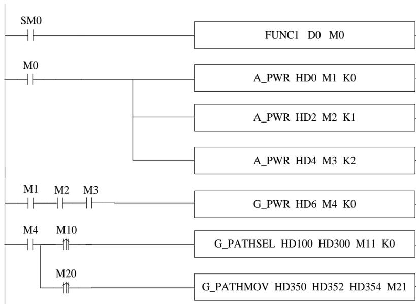
其中，FUNC1 功能块用作给 G\_PATHSEL 指令赋值，M0 开启各轴的使能，当三个轴使能都打开时（标志位 M1、M2、M3 为 ON），开启轴组使能。在轴组使能开启后（标志位 M4 为 ON），当 M10 置 ON 时执行设置好的 G\_PATHSEL 指令，当指令的完成标志 M11 置 ON 后通过将 M20 置 ON 来执行设置好的 G\_PATHMOV 指令。
