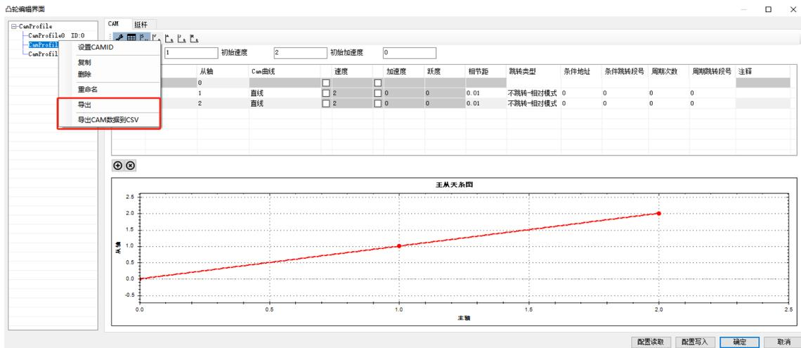
【导出】：导出凸轮表，生成的文件可供凸轮表编辑界面再次导入，生成的文件仅为描述文件，不包含凸轮表中的点。
