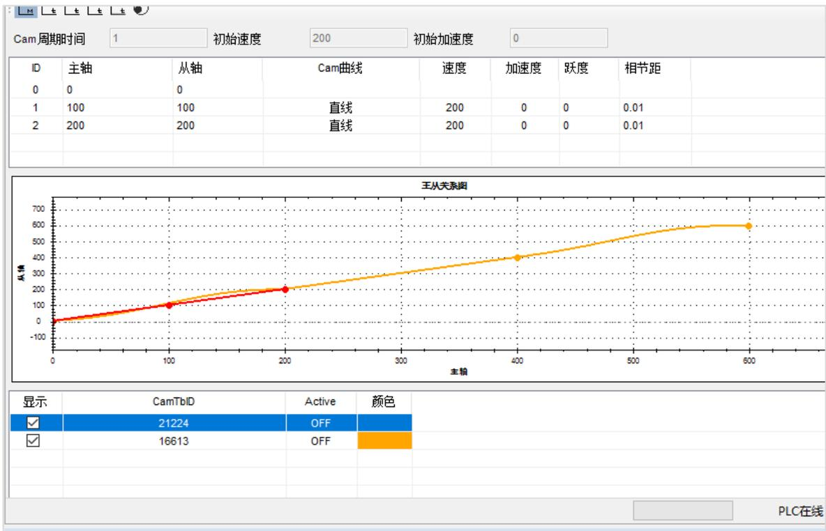
选中对应的 camTblID，点位数据显示部分，会显示对应的凸轮点位信息；勾选 camTblID 栏前的【显示】，决定是否显示对应的主从关系图。
