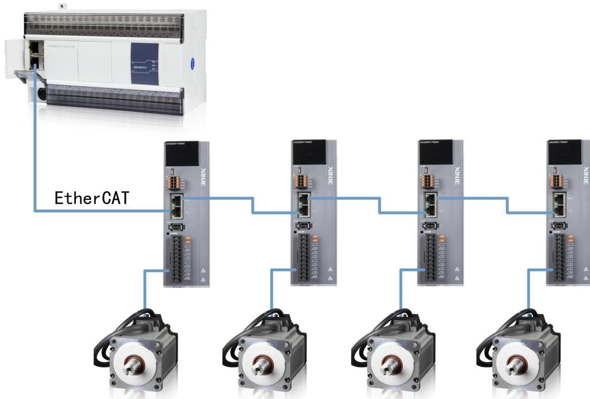
**注意：**XDH、XLH、XG2 系列 PLC 中只有 LAN2 口支持 EtherCAT 通讯。伺服驱动器的两个通讯网口遵循“下进上出”的原则，即 XDH、XLH、XG2 的 LAN2 口必须与第一台伺服的 LAN1 口下面的网口相连，再由第一台伺服上面的网口与第二台伺服下面的网口相连，依此类推。
