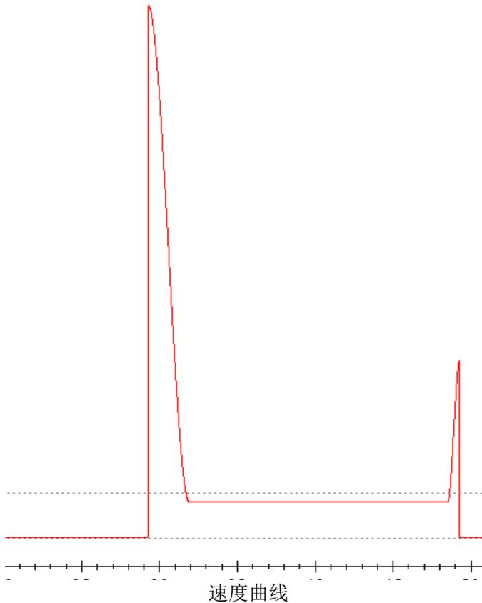
从上述曲线可以看出，在防反转曲线下，相同的参数，凸轮轨迹不会出现反转，从速度曲线可以明显的看到，该防反转曲线讲速度进行了三段处理。
