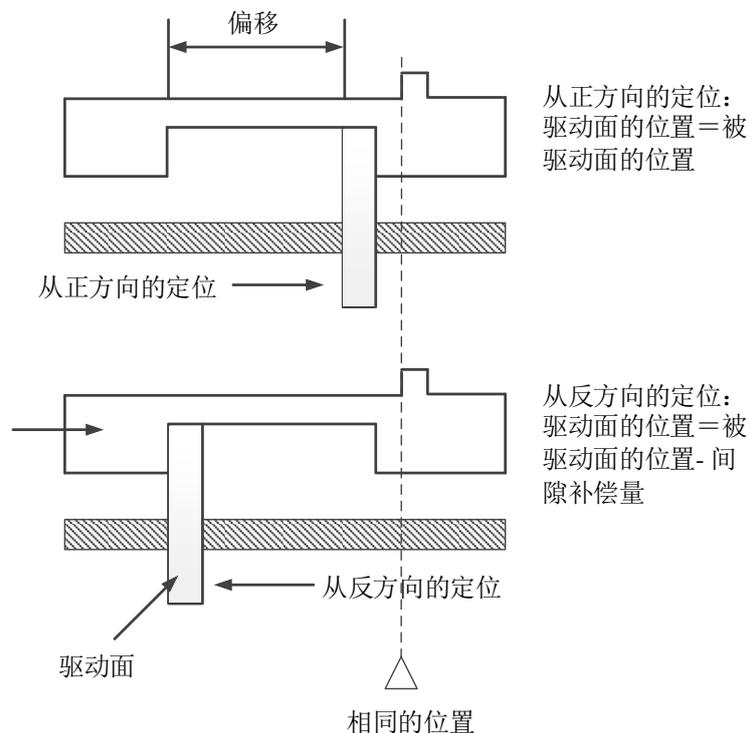
背隙补偿值变化量表示间隙值与反向后主运动位移量的比值，比如背隙补偿值为 4，背隙补偿变化量为 0.5；当主运动移动量为 6 是，对应的间隙值应为 3，当间隙值达到设定值 4 后，无论主运动移动量多少，间隙值都不变。
