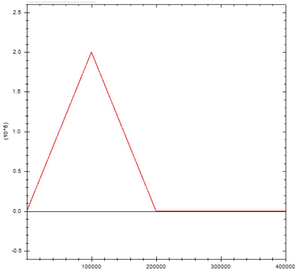
图中 X 轴为主轴位置，Y 轴为从轴位置，当主轴位置由 0 到 200000 时，从轴根据凸轮表点位做相应的运动，当主轴位置由 200000 到 400000 时，此时由于凸轮表为非循环执行，凸轮运行已结束，从轴位置不发生变化。
