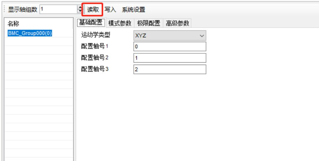
点击【读取】可进行所有轴组的所有参数的读取。
