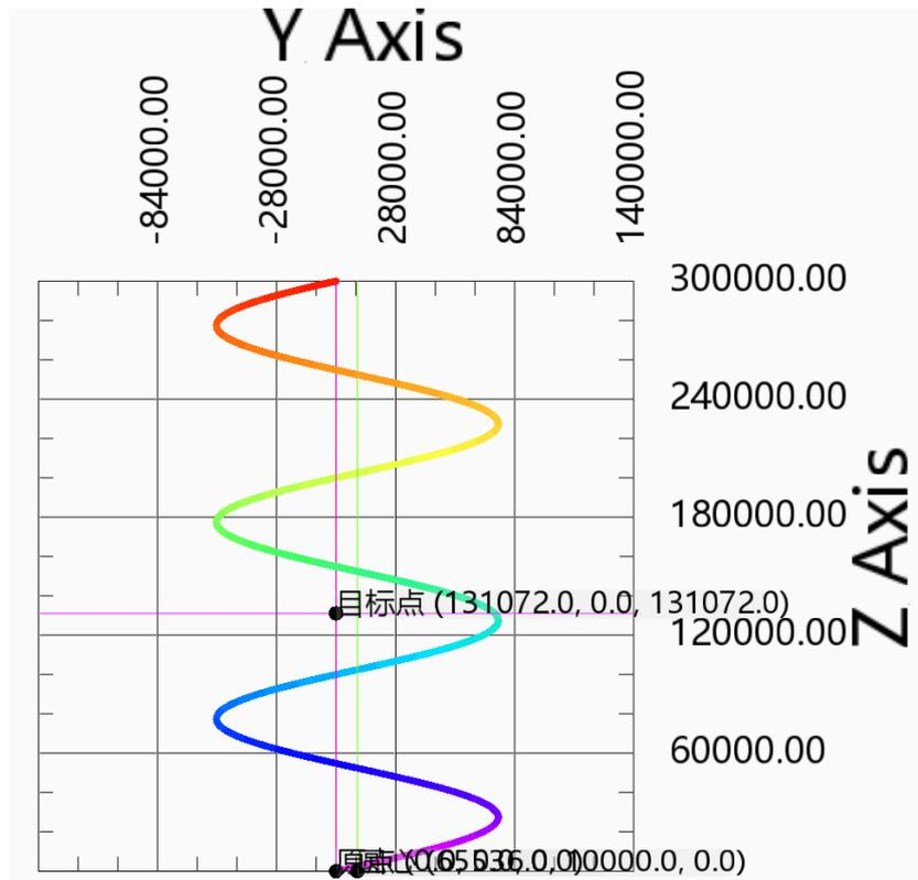
动作分解：XOY 平面两轴做平面圆动作，圆轨迹由所选平面上起点，圆心，目标标点坐标和路径选择决定，圆运动重复圈数 3 次；Z 轴匀速直线运动，运动距离为圈数×螺距；三轴同时启停，三轴线速度分解为 XOY 平面线速度和 Z 轴直线速度。
