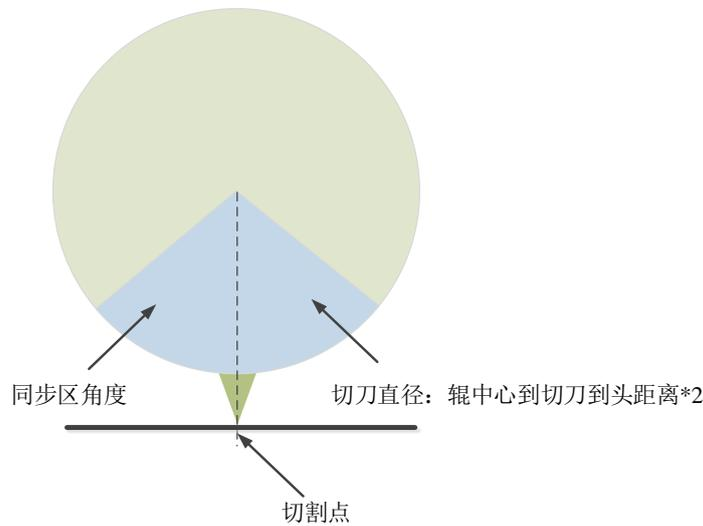
【切刀个数】：刀辊上切刀的数量，默认值为 0，根据实际刀具设定，如果刀辊上只有 1 个切刀，设为 1，切刀轴旋转 360 度进行一次切割；则需要将切刀的启动位置调整至剪切点的正上方（180 度位置）；如果刀辊上有两个切刀，从轴剪切一段料长仅需要旋转半圈，则需要将切刀启动位置调整至剪切点的 90 度位置，依次进行多刀调整。如果切刀启动点位置有偏差，则无法保证剪切过程在同步区进行。
